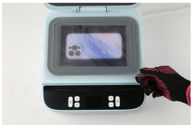
6. Sobald die eingestellte Temperatur erreicht ist, drücken Sie kurz die Starttaste, um mit dem Vakuumieren und der Hitzeübertragung zu beginnen;
