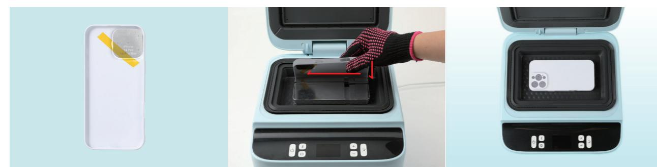
4. Verwenden Sie einen Sublimationsdrucker, um die Sublimationsfolie zu bedrucken (die matte Seite ist die Druckoberfläche);Nachdem die grüne Anzeigeleuchte 10 Minuten lang durchgehend leuchtet, legen Sie die Sublimationsfolie (matte Seite nach oben) auf die obere Heizplatte, um sie mindestens 5 Minuten zu trocknen. (Die Oberflächentemperatur liegt über 40°C.)
