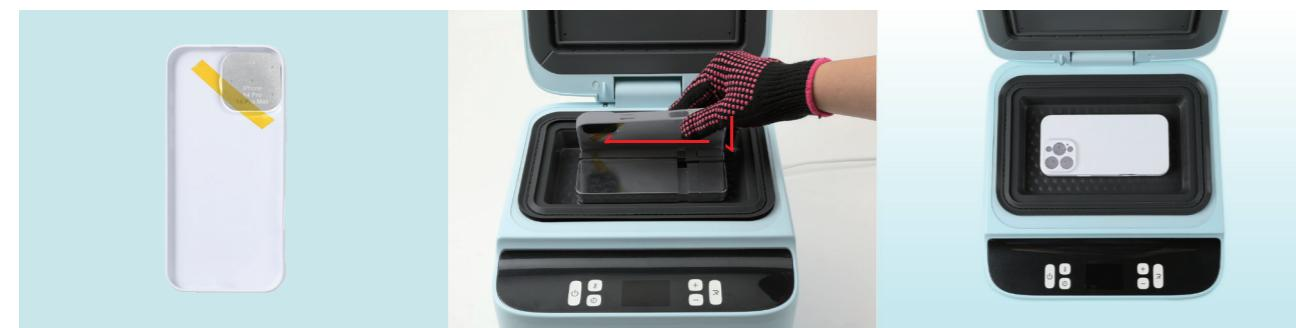
4. Utilisez une imprimante à sublimation pour imprimer le film de sublimation (le côté mat est la surface d'impression) ;Une fois que le voyant vert reste allumé pendant 10 minutes, placez le film de sublimation (côté mat vers le haut) sur la plaque chauffante supérieure pour le sécher pendant au moins 5 minutes.(La température de surface dépasse 40 °C.)
