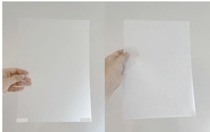
En cas de bourrage papier ou d'impression incomplète, collez une étiquette sur le bord inférieur du film. Si le problème persiste, fixez une feuille A4 à l'arrière du film pour améliorer l'alimentation et la détection par les capteurs.
