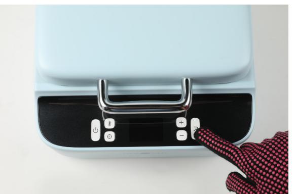
7. Lorsque le transfert thermique est terminé, portez des gants thermorésistants pour ouvrir la plaque chauffante et décoller le film de sublimation pendant qu'il est chaud. Retirez la coque du support.
