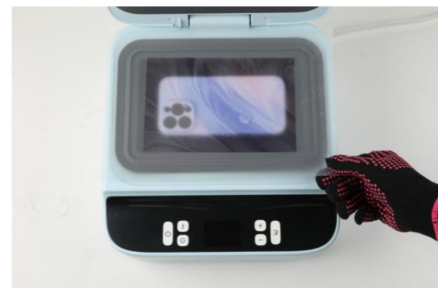
6. Una volta raggiunta la temperatura impostata, premere brevemente il pulsante Start per avviare la sigillatura sottovuoto e il trasferimento di calore;
